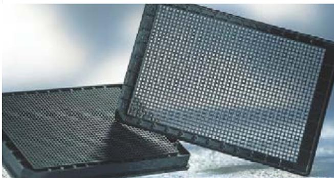
Microplaque en polystyrène avec fond en verre borosilicaté achromatique d'épaisseur 175 µm, de format standard. De coloris noir opaque pour l'imagerie de haute résolution, la fluorescence.
