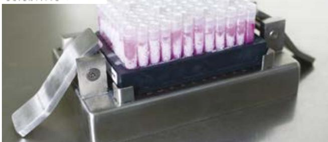
Bank-It und CryoBank Werkzeug zur Rückgewinnung von Kryoröhrchen. Ermöglicht die Auswahl der Röhrchen, die aus einem kompletten Rack entnommen werden sollen.
