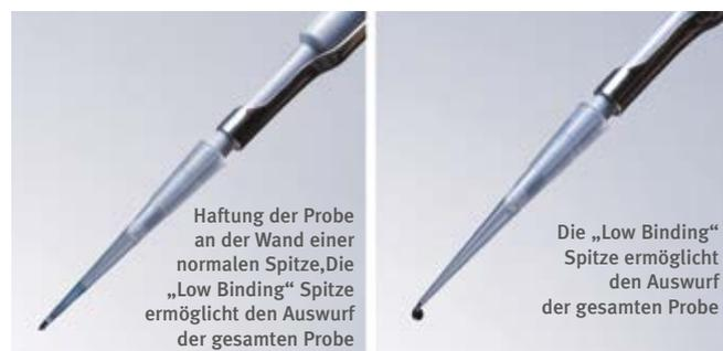
Haftung der Probe an der Wand einer normalen Spitze, Die „Low Binding“ Spitze ermöglicht den Auswurf der gesamten Probe
