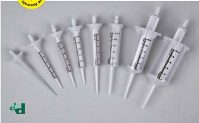
Die 3D Dispenser Tips werden für das wiederholte Dispensieren von Volumina zwischen 10 µl und 5 ml verwendet und sind perfekt auf die Eppendorf Multipette 4780 abgestimmt. Sie sind in sechs Volumina erhältlich: 0,5 ml, 1,25 ml, 2,5 ml, 5 ml, 12,5 ml, 25 ml und 50 ml, in steriler Einzelverpackung oder Nicht steriler Ausführung. Die 3D-Dispenserspitzen bestehen aus Polypropylen und sind graduiert.
