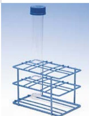
Rack aus epoxidbeschichtetem Stahl für Hybridisierungsröhren (Ø < 40 mm).
