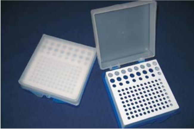
Stapelbares System, zum Einfrieren bis -80 °C.
