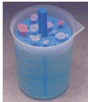
Schwimmendes Rack aus Schaumstoff, das in 500-ml-Becher passt.
